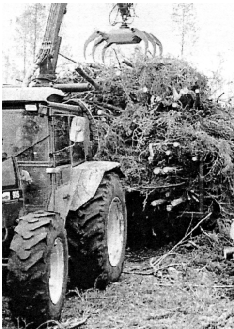
Рис. 5.8. Сельскохозяйственный трактор с прицепом, на котором установлен гидравлический уплотнитель (фотография: Институт эффективности труда).
