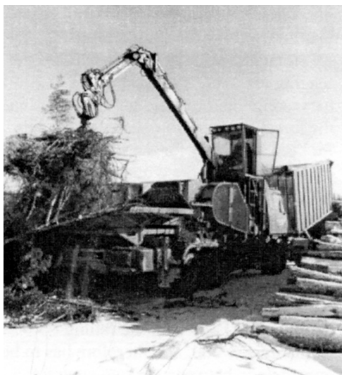
Рис. 5.27. Барабанная дисковая машина на шасси грузового автомобиля, осуществляющая переработку лесосечных отходов (фотография: BENET).
