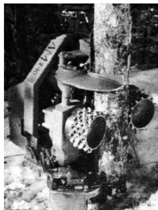
Рис. 5.6. Устройство АМ 240, предназначенное для валки, очистки и раскряжевки деревьев (Mefor Oy), навешиваемое на гидроманипулятор сельскохозяйственного трактора (фотография: Институт эффективности труда).
