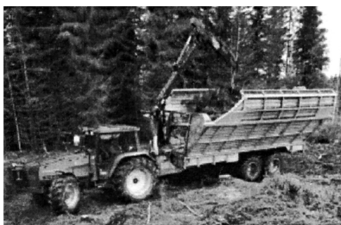
Рис. 5.24. Лесовозный прицеп ХавуХукка, способный уплотнять лесосечные отходы, буксируется сельскохозяйственным трактором (фотография: Вапо ой Энержи).
