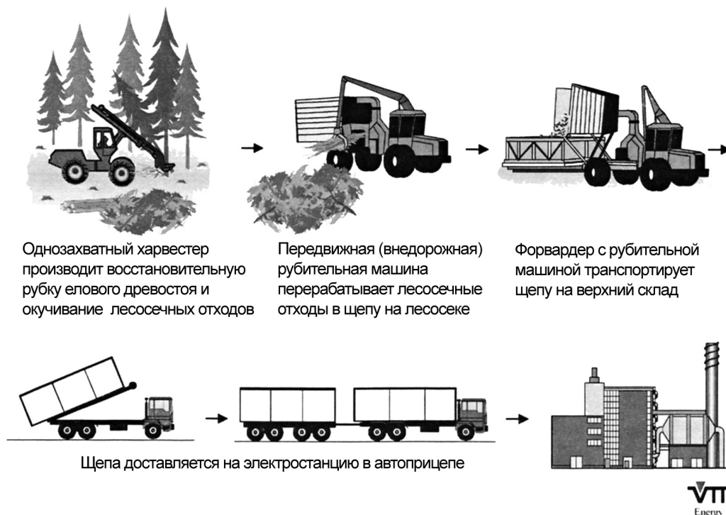
Рис. 5.30. Основные этапы процесса переработки щепы на лесосеке (Источник: VTP Энерджи).
