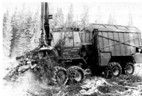
Рис. 5.31. Передвижная рубительная машина производит переработку лесосечных отходов (фото: BENET).
