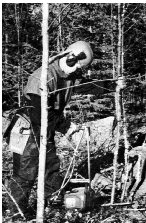
Рис. 5.3. Бензопила, оборудованная валочной рамой с ручками, повышает уровень эргономики и улучшает условия труда при валке и пакетировании тонкомерных деревьев (фотография: TTS Institute).
