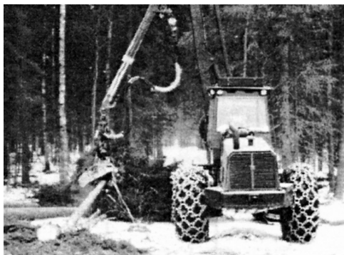
Рис. 5.2. Применение однозахватного харвестера в рубке главного пользования (фотография: BENET).
