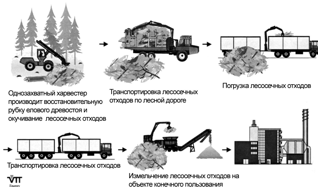
Рис. 5.32. Переработка на щепу и измельчение лесосечных отходов на объекте конечного пользования (Фотография: VTT Энерджи).
