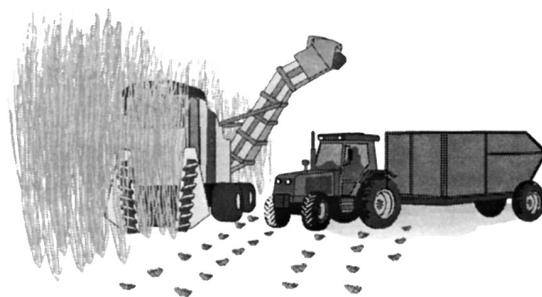
Рис. 3.6. Пример заготовки ивняка с прямой переработкой в щепу (Danfors et al. 1998).
