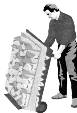
Рис. 5.18. Упаковочная рама, разработанная компанией Тулипуу ко. (Tulipuuko.), предназначенная для продажи дровяной древесины. Источник: Институт эффективности труда.
