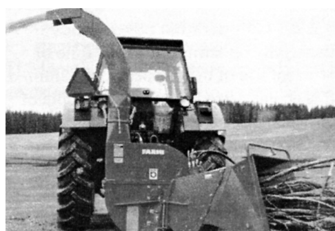
Рис. 5.12. Дисковая рубительная машина, установленная на подъемнике трактора. Источник: Farmi-brochure.
