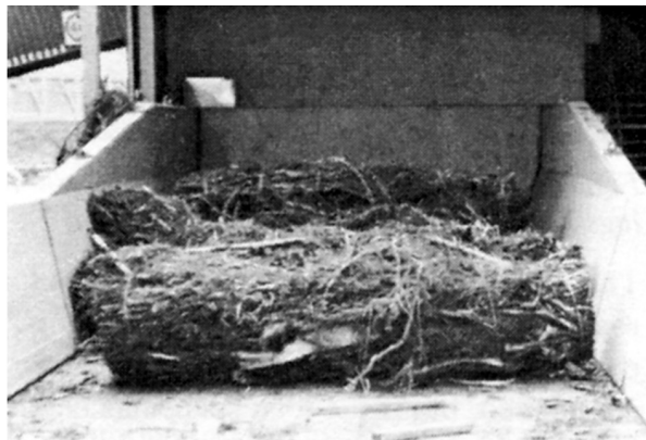
Рис. 5.36. Бревна из лесосечных отходов на столе подачи сырья на переработку (фотография: УПМ-Киммене Лтд)
