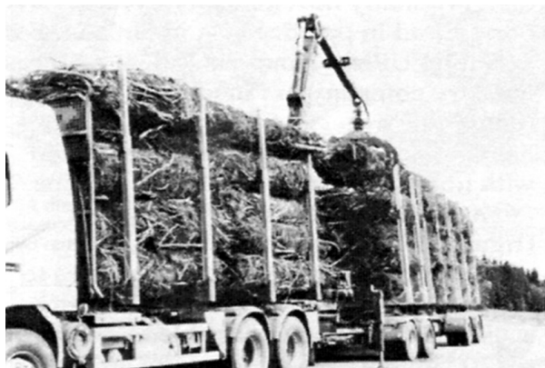
Рис. 5.35. Погрузка бревен из лесосечных отходов в семиосный лесовоз (фотография: УПМ-Киммене Лтд).
