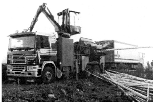
Рис. 5.19. Цепная сучкорезная машина ударного типа на шасси грузового автомобиля (фотография: VTT Энерджи).
