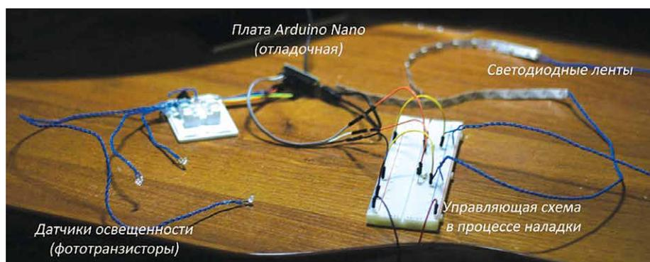
**Рис. 7. Демонстрационная физическая модель помещения**
