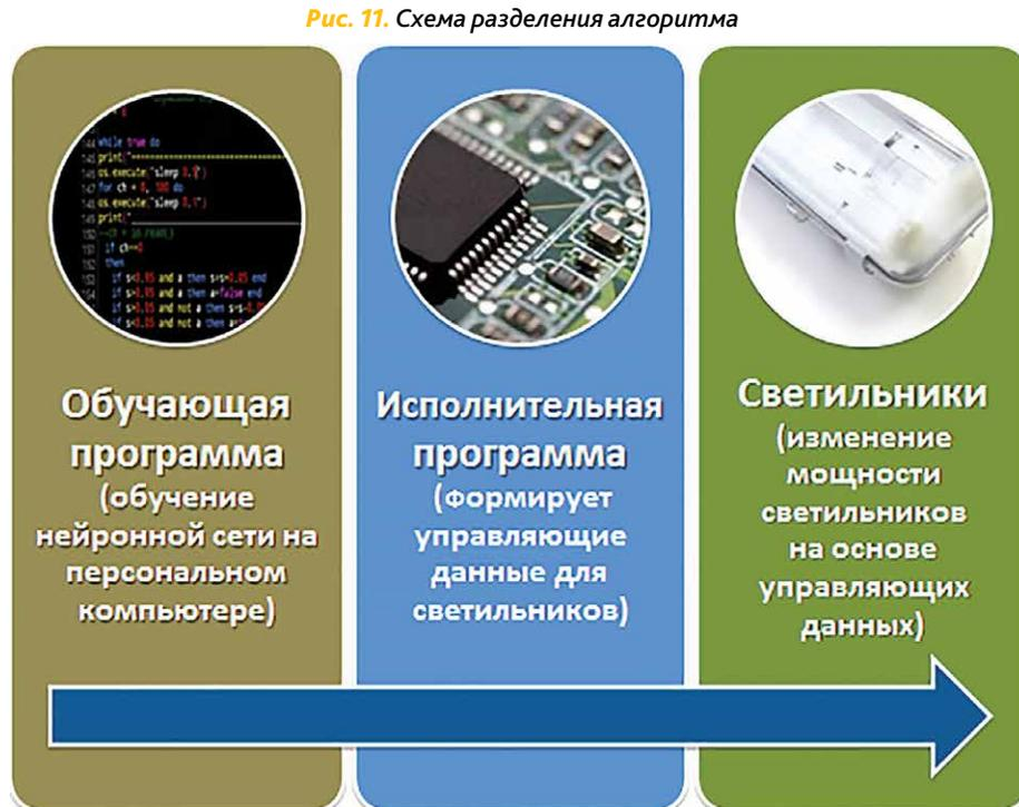
ронной сети производить в программе на персональном компьютере, а полученные веса записать в ROM микроконтроллера для использования в исполнительной программе. Таким образом, имея нужные значения весов, исполнительная программа на основе входных сигналов выдаст управляющий сигнал. ■
