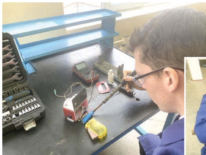
Монтаж элементов электрической схемы генератора открытия двери
