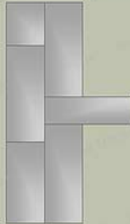
Б. Перевязка двухслойной кладки
