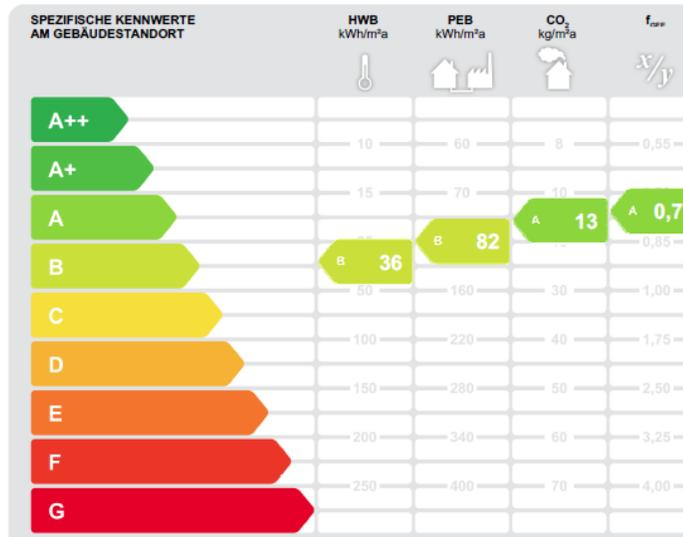
**HWB:** Der Heizwärmebedarf beschreibt jene Wärmemenge, die in einem Raum bereitgestellt werden muss, um diesen auf einer normativ geforderten Raumtemperatur (bei Wohngebäude 20°C) halten zu können.
