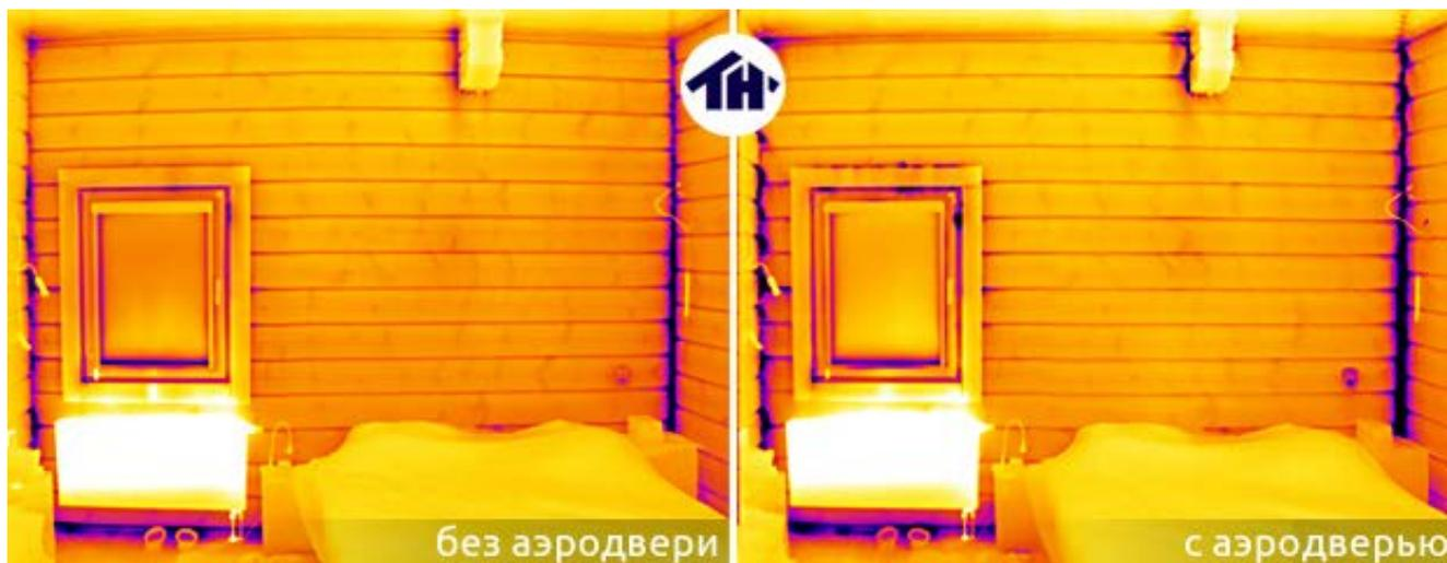
Внутренняя тепловизионная съемка в помещении на первом этаже. Перепад давлений в естественных условиях (из-за тяги и ветра, без аэродвери) составляет 7 Па. Такого перепада давлений достаточно для выявления слабых мест с фильтрацией воздуха. На термограмме, снятой при понижении давления аэродверью на 35 Па, новых мест фильтрации не проявляется.
