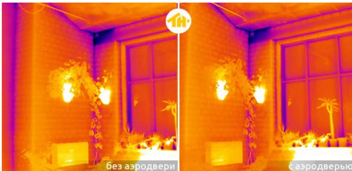
Температурная аномалия на термограммах этого участка стены одинаково проявляется как без использования аэродвери, так и при создании в помещении разряжения. Это позволяет точно сделать вывод, что в этом месте нет фильтрации воздуха, аномалия связана с повышенной теплопроводностью конструкции и должна быть проверена по санитарно-гигиеническому показателю теплозащиты (по точке росы).
