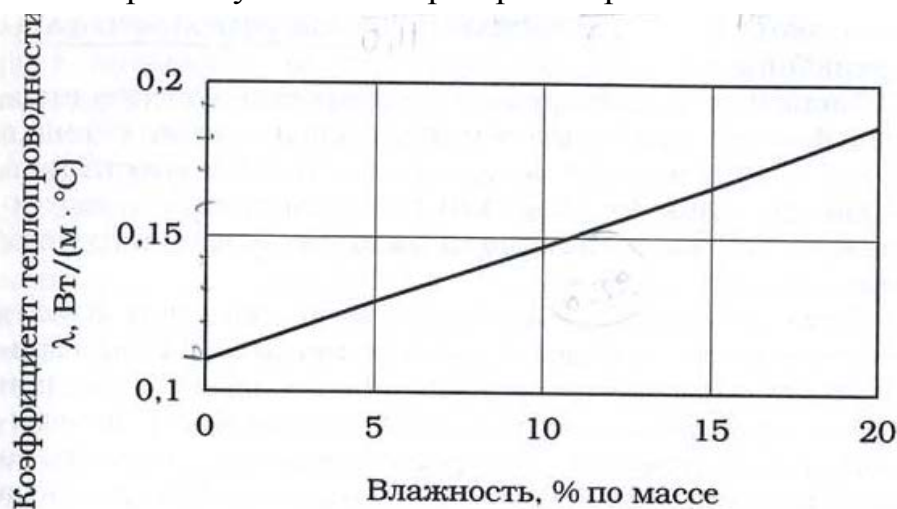
Рис. 5: Зависимость теплопроводности \lambda при температуре 10^{\circ}\text{C} от влажности (по массе) ячеистого бетона плотностью 500 \text{ кг.м}^3
