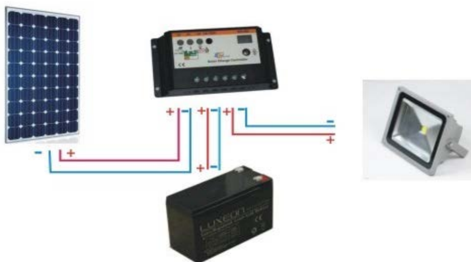
Рисунок 1.1 – Схема автономного электроснабжения постоянным током.
