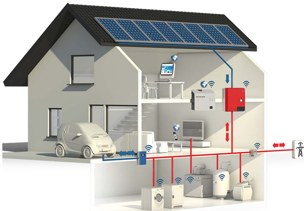
Рисунок 2.3 – Сетевая солнечная станция в режиме самопотребления.
