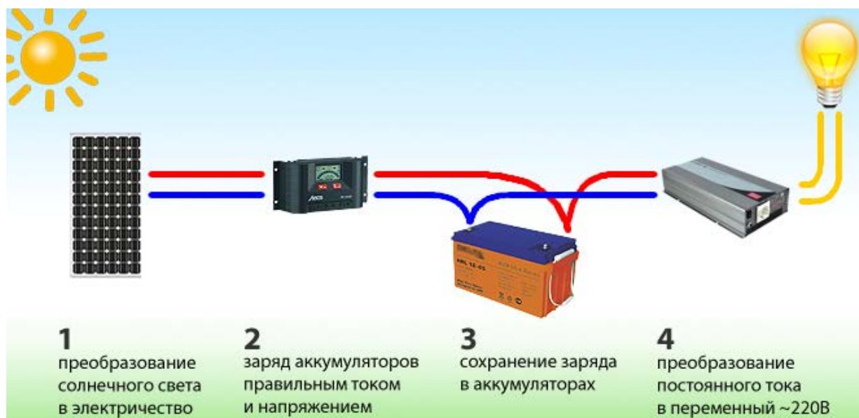
Рисунок 1.2 – Схема автономного электроснабжения переменным током.
