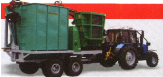
2а - рубильная машина БЕЛАРУС МР -25-02 с контейнером- перегрузчиком
