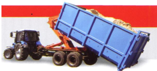
Зв - полуприцеп контейнерный БЕЛАРУС ПК-12 для сбора и транспортировки щепы к энергоисточникам
