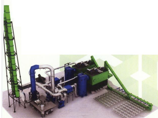
Рисунок 5. Энергоустановка для сжигания щепы из лесосечных отходов и НДС естественной влажности
