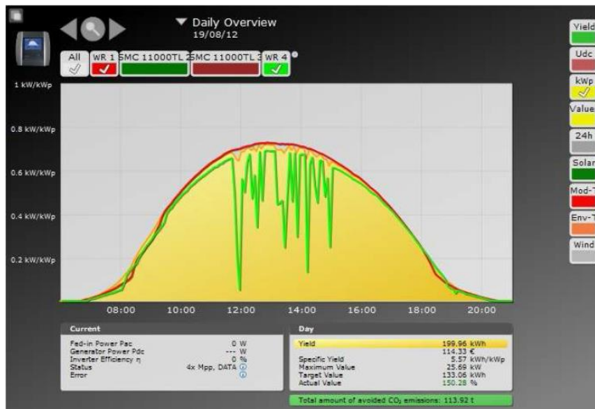
Рисунок 2.6 – Работа СЭС с двумя инверторами, один из которых поврежден
