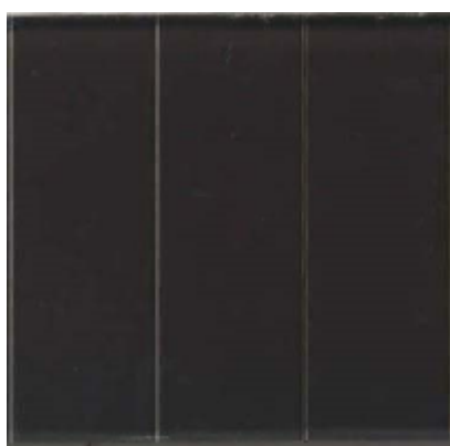
Рисунок 4.2 – Элемент и солнечный модуль из аморфного Si
