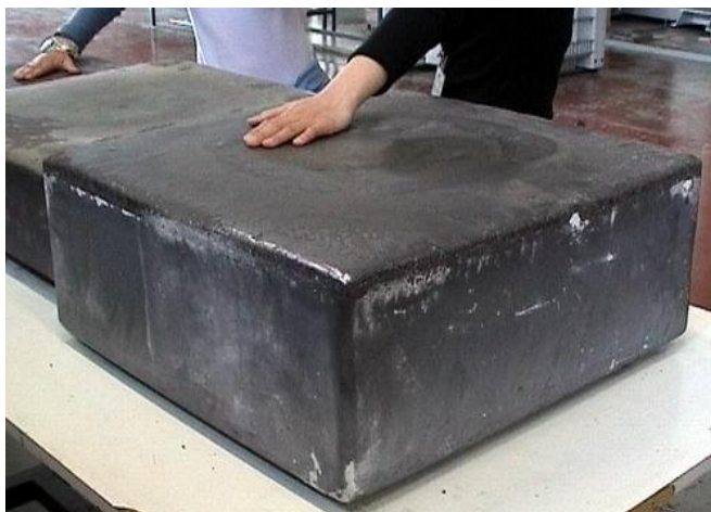
Рисунок 3.6 – Выращенная плита поликристаллического кремния
