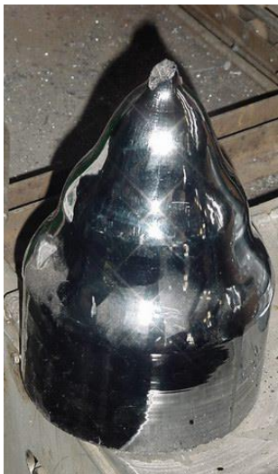
Рисунок 1.14 — Слиток, выращенный методом Чохральского и солнечный модуль из монокристаллического Si
