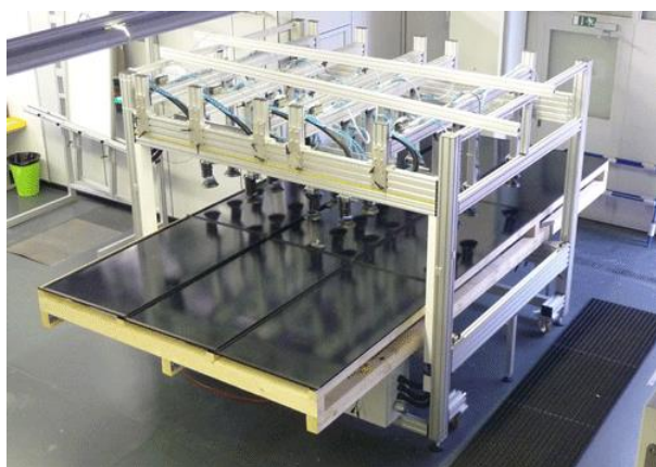
Рисунок 2.25 — Пример испытания на прочность для модулей «солнечной черепицы»
