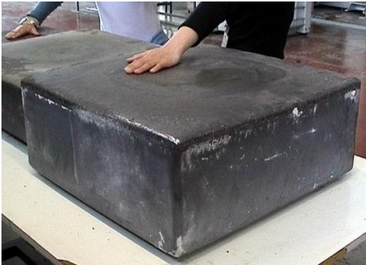
Рисунок 1.16 — Выращенная плита поликристаллического кремния
