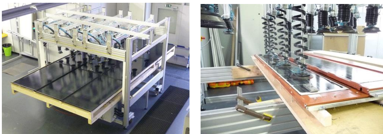
Рисунок 4.6 – Пример испытания на прочность для модулей «солнечной черепицы»
