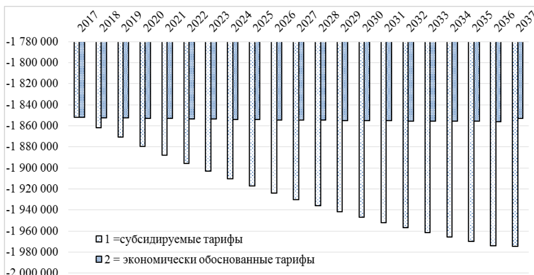
Рисунок 2.3.1 Динамика показателя чистого дисконтированного денежного дохода, рассчитанного накопленным итогом для системы приточно-вытяжной вентиляции для жилого здания в г. Могилеве, долларов США
