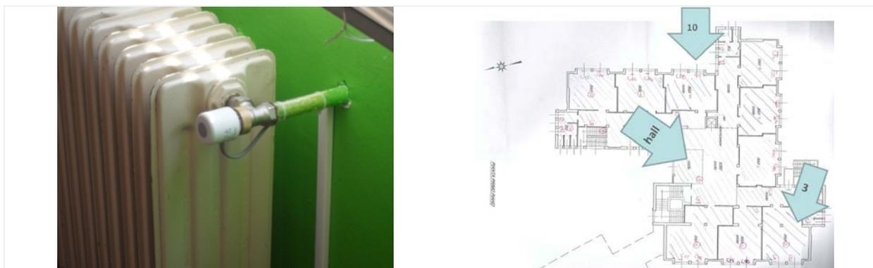
Применявшаяся в данном случае технология состоит в том, что выбирают три разных помещения в разных квартирах разного назначения, с различными климатическими условиями (экспозицией), чтобы рассчитать сбережение для каждого помещения и экстраполировать результаты на все здание.
